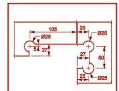
OBS: DIMENSÕES MÁXIMAS DO VIDRO: 2000x700mm (larg x alt) utilizando 2 peças
