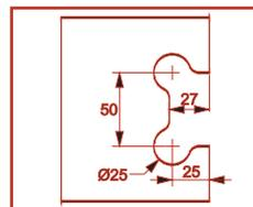
OBS: DIMENSÕES MÁXIMAS DO VIDRO: 1000x800mm (larg x alt) utilizando 2 peças
