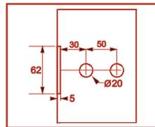
OBS: DIMENSÕES MÁXIMAS DO VIDRO: 1000x2200mm (larg x alt) ou 900x2600mm (larg x alt) utilizando 2 peças
